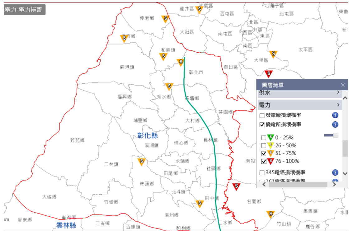
圖 1-3-15 模擬變電所損壞機率
