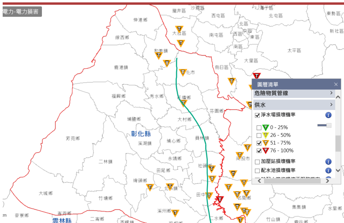
圖 1-3-16 模擬淨水廠損壞機率
