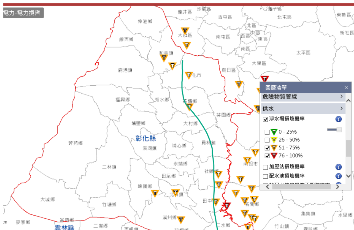
圖 1-3-16 模擬淨水廠損壞機率
