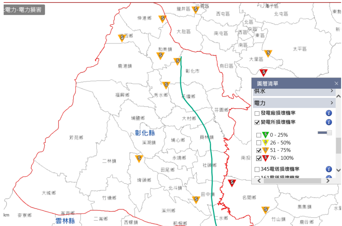
圖 1-3-9 模擬變電所損壞機率
