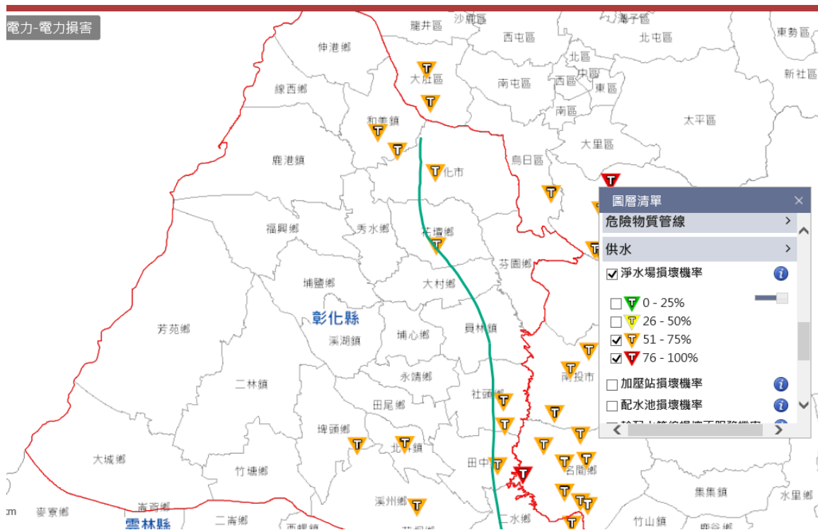
圖 1-3-10 模擬淨水廠損壞機率
