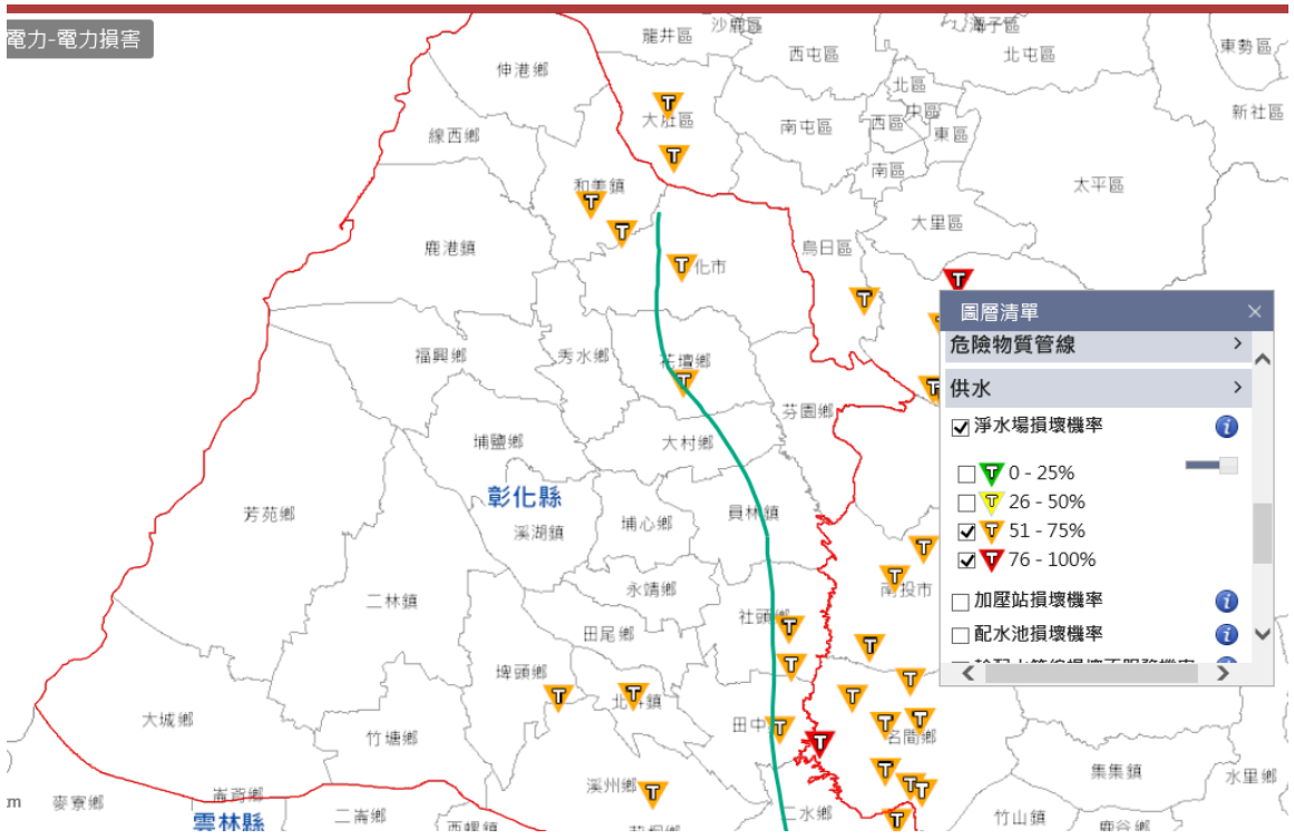
圖1-3-10模擬淨水廠損壞機率
