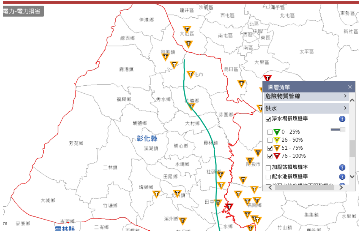
圖 1-3-9 模擬淨水廠損壞機率
