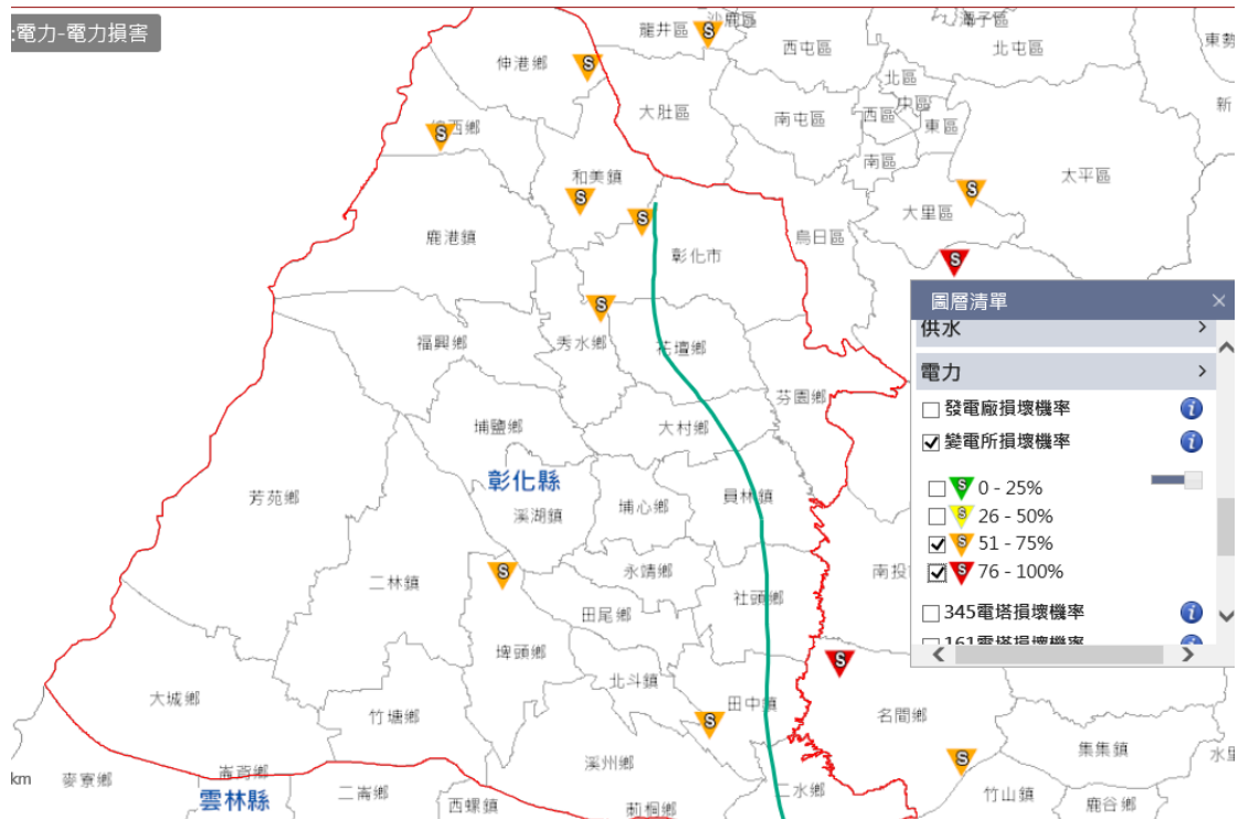
圖 1-3-15 模擬變電所損壞機率
