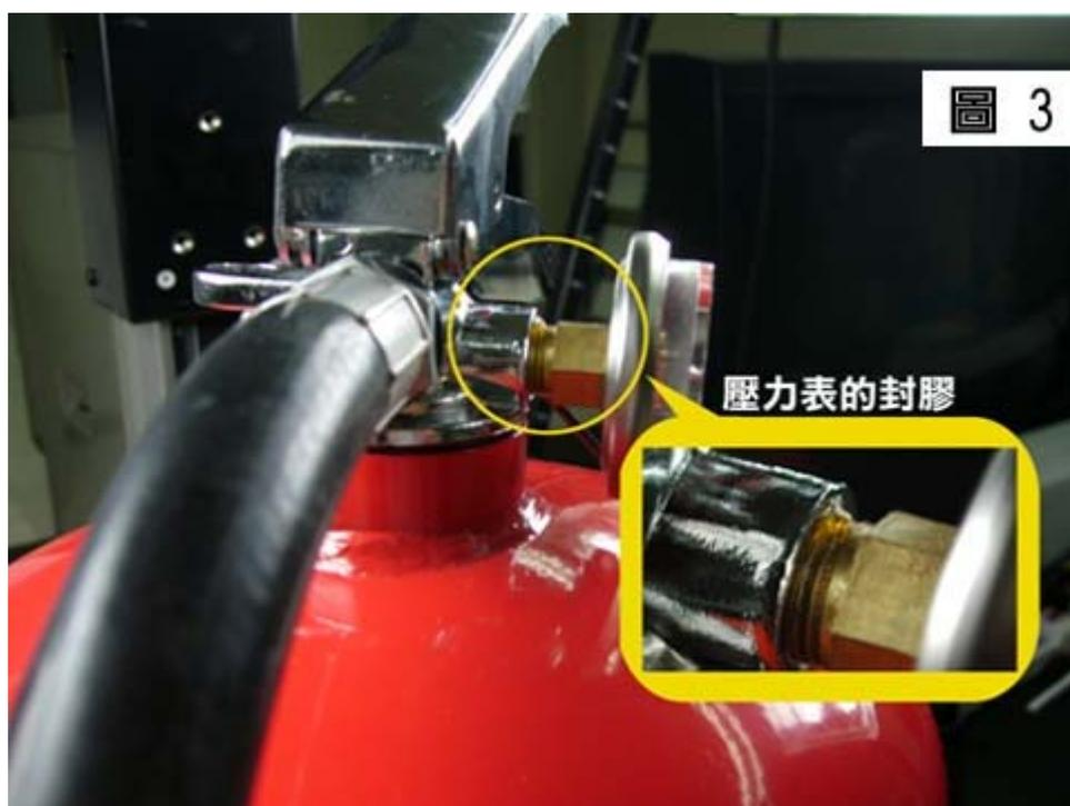
此外滅火器上有一個壓力表，應該也要拆下檢驗，因為壓力表必須校對，才能顯示正確刻度，而為了檢驗廠商有無實際實行，一樣在壓力表與噴頭接合處畫一條線，因為壓力表組裝時會用封膠加以固定，而封膠可以在接合處看得出來(圖3)，如果所畫直線及封膠之位置均未變動，這個廠商檢驗費用又比別人低，就算廠商大言不慚的標示檢驗合格，也不要相信，因為滅火器檢查都有一定的成本，奉勸大家千萬不要貪小便宜，更要為了自身安全，趕快將筆準備好，開始在滅火器上畫線吧。
