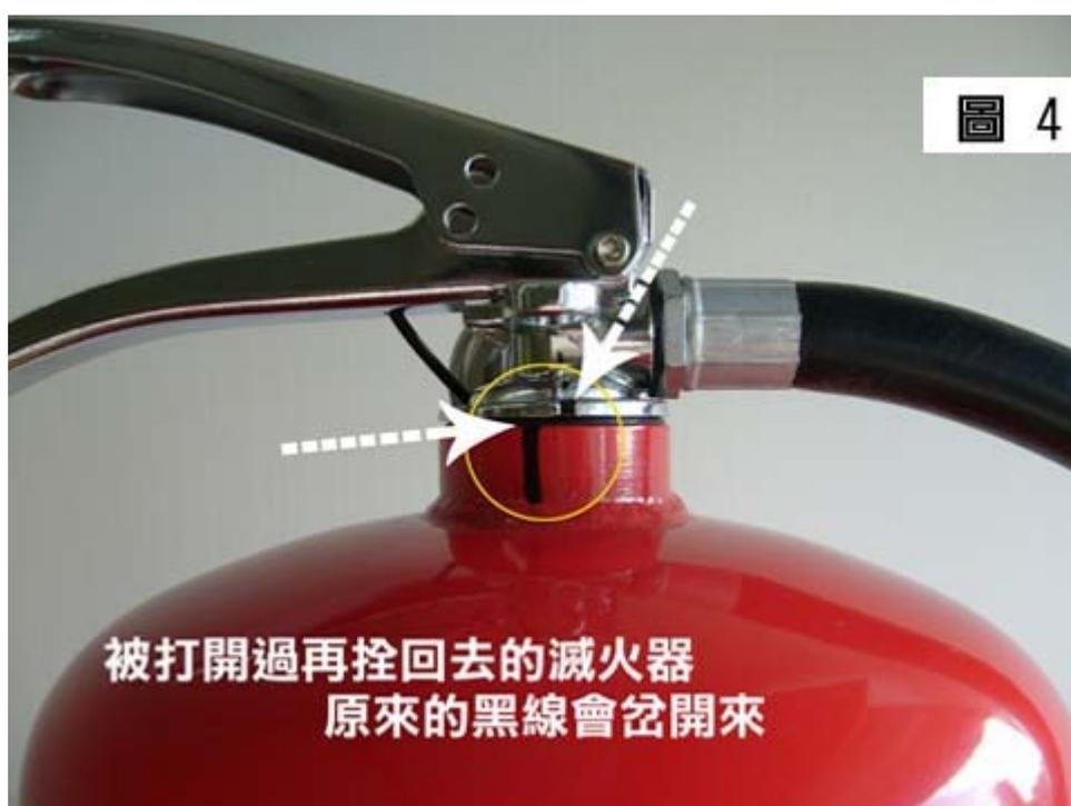
當然很多人會想我隨便打開一下，再鎖回去就會出現標線岔開之現象，何難之有？事實上乾粉滅火器只要打開過，蓄積在滅火器內的壓力會漏掉，一定要重新充填壓力，否則壓力表的指針會歸零。打開滅火器及充填壓力，這兩個動作已是檢驗中最麻煩的步驟，其他諸如檢查乾粉是否結塊、內管有無老化都是輕而易舉的事，負責檢驗的廠商，既然打開了，就會加以檢查，實在沒有必要大費周章將滅火器打開，重新灌氣後，只為了要讓這條線看起來沒有連在一起。
